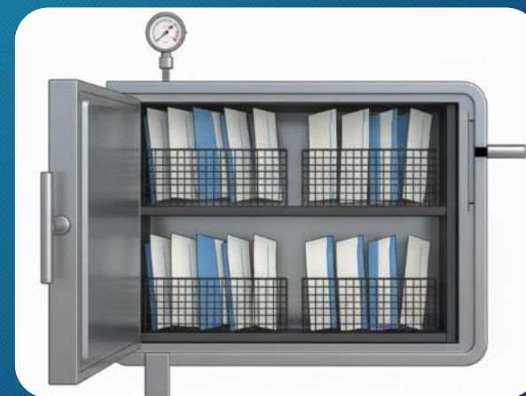
CARGA DE EMBALAGEM POSICIONADOS DENTRO DE CESTOS ARAMADOS
